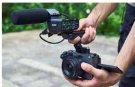
FX30 机身小巧轻便，采用平顶设计，带有螺纹配件连接点，便于安装在稳定器或者其他配件上进行手持拍摄和低角度拍摄。FX30 还配备一个 XLR 适配器手柄，可用于低机位拍摄，通过两个 XLR 音频输入和一个支持 4 通道录音的 3.5mm 立体声 Mini 接口，支持多种音频输入以清晰地捕捉音频，外部麦克风也可以通过 Mi 多接口热靴或麦克风接口连接到摄影机。此外，FX30 也内置了立体声麦克风。FX30 配备两个存储卡插槽，同时兼容 CFexpress Type A 卡和 SDXC/SDHC 卡，支持新发布的大容量 CFexpress Type A 存储卡。
